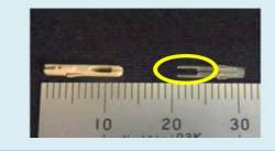
$\frac{\text{Fine slits}}{* 0.15 \text{ mm} \pm 0.02 \text{ mm}}$ wide slits
